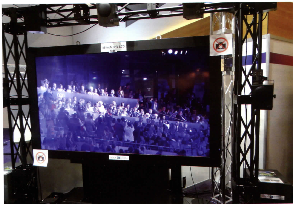
Figuur 1. Het 85-inch 'super high vision' lcd scherm (8K) van het Japanse NHK. De resolutie is 7680 x 4320 pixels en de 'frame rate' van 120 Hz is een verdubbeling van de huidige norm. Een verbetering van het televisiebeeld vergt ook ondersteuning in de infrastructuur, zoals betere camera's en snellere verbindingen. Het 'Science and Technology Laboratory' (STRL) van NHK ontving voor haar gehele werk op dit gebied de 'IBC2012 Award for the International Honour for Excellence'. (foto's: Hans van Thiel)
