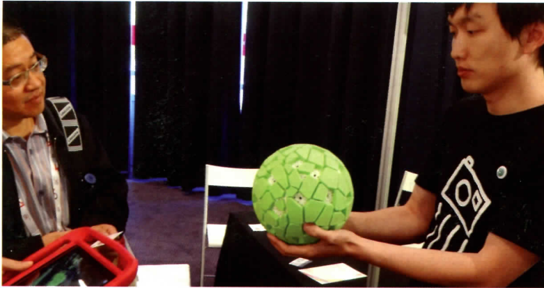
Figuur 2. De 'Throwable Panoramic Ball Camera', ontwikkeld door de TU Berlin in samenwerking met de Universiteit van Hongkong. De 36 camera's in de omhooggeworpen bal maken op het hoogste punt allemaal tegelijk een foto. Sensoren aan het beeldscherm (tablet) en visuele software zorgen ervoor dat in elke richting (horizontaal en verticaal) een projectie wordt afgebeeld. Degene die het scherm vasthoudt en beweegt, bepaalt zo steeds, dynamisch, zijn of haar eigen gezichtspunt.
