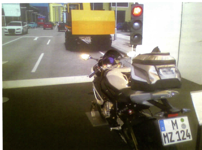
Figuur 2. Een proefopstelling demonstreert hoe een motorfiets kan communiceren met verkeersinstallaties en/of andere weggebruikers. De tas bevat het (experimentele) embedded systeem met de radioantenne.
